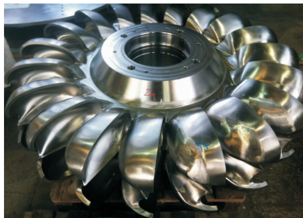
Esempio di Girante Pelton (fonte EPF Energy)
